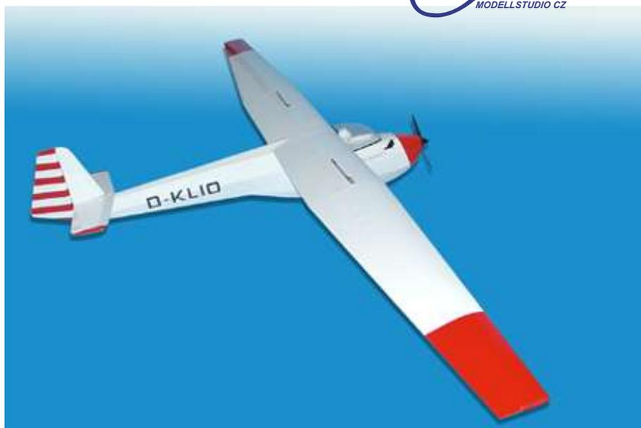
**RC - Funktionen:** Seitenruder, Höhenruder, Speed Control (Gas) and Querruder, Airbrakes
